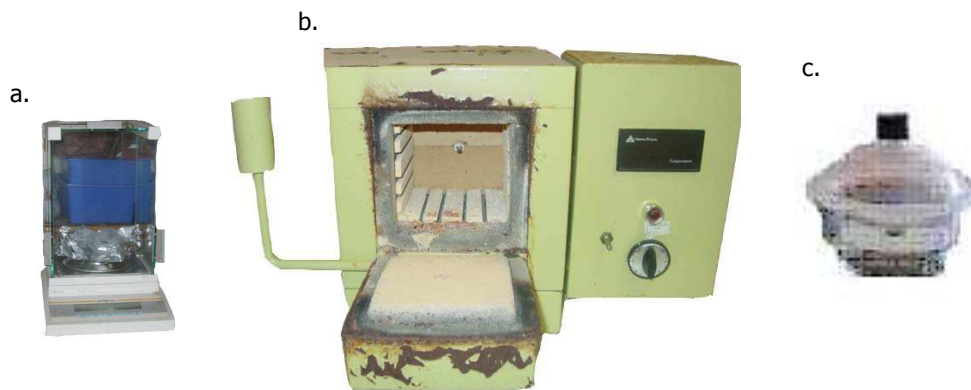
Figura 7. Procedimiento empleado para hallar el porcentaje de materia orgánica por ignición. (a) Balanza analítica (b) Mufla terrígeno (c) Desecador.
