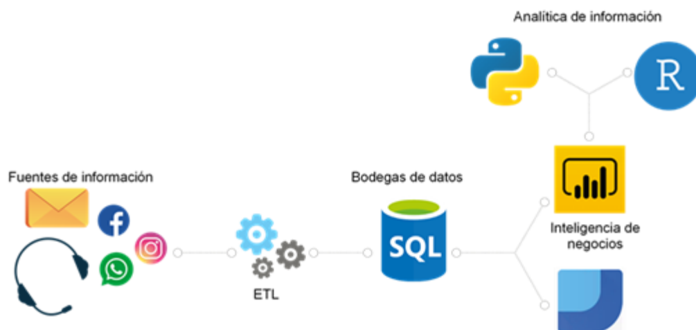
Figura 5-2: Estructura de flujo de datos en aplicativos para E Call You S.A.S., elaboración propia basado en [22].
