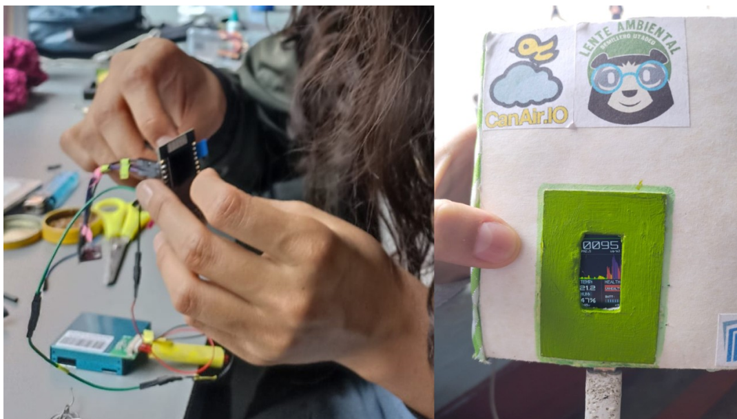
Figura 4 – Ensamble y resultado de Monitor CanAirIO Plantower PMS7003/G7
