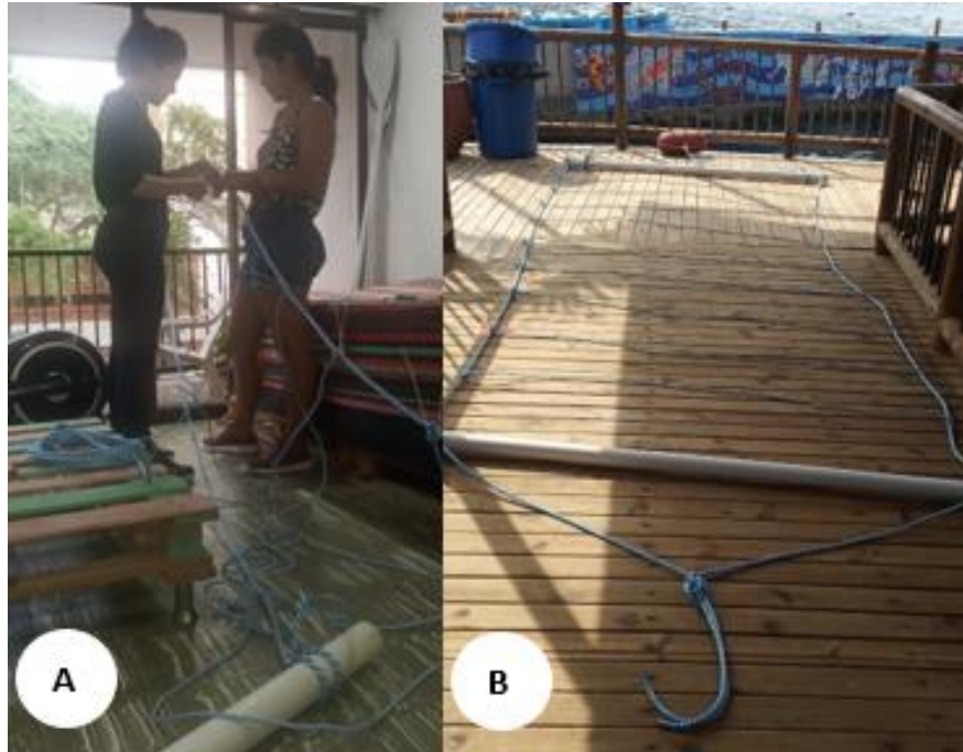
Figura 23. Construcción de guardería tipo tendedero; A) fijación de las cuerdas por nudos y precintos de plástico en cada unión, B) prototipo de vivero terminado.
