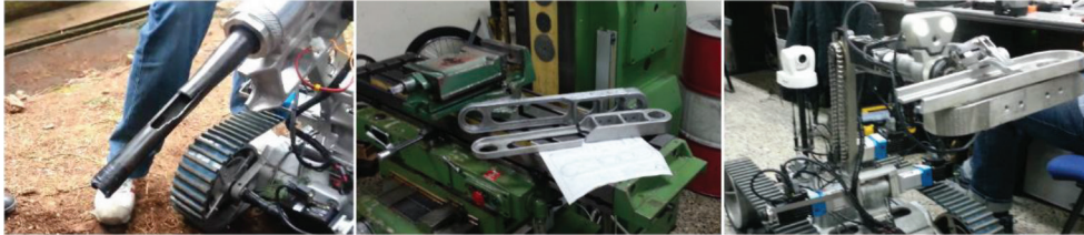
Figura 14 – Cuerpo del cañón destrozado por la explosión del mismo (izquierda). Eslabón del antebrazo mecanizado junto al eslabón fracturado (centro). Reemplazo del eslabón fracturado en el brazo manipulador (derecha).
