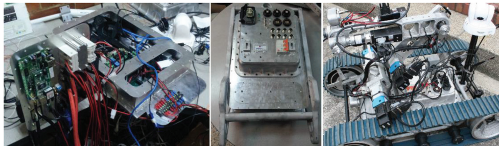
Figura 8 – Caja electrónica con los componentes montados y conectados (izquierda). Caja electrónica completamente armada y cerrada (centro). Brazo manipulador conectado a la caja electrónica (derecha).
