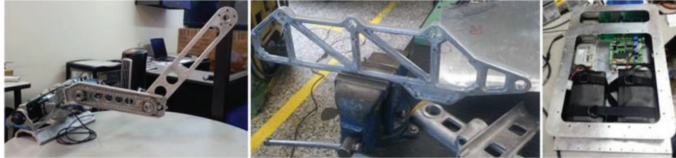
Figura 7 – Eslabones del brazo manipulador ensamblados a la cadera del robot (izquierda). Partes fundidas y mecanizadas de la plataforma móvil y listas para ensamble (centro). Caja del sistema electrónico con algunos componentes dentro de ella (derecha).
