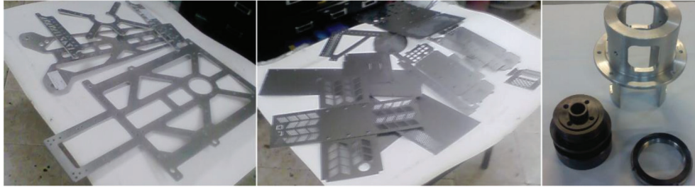
Figura 5 – Chapas de duraluminio cortadas por agua (izquierda). Chapas de acero punzonadas (centro). Piezas mecanizadas de diversos materiales (derecha).
