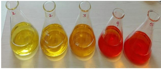
Figura 1. Soluciones con las concentraciones de cromo hexavalente. De izquierda a derecha 10, 50, 100, 500 y 700 mg/L.
