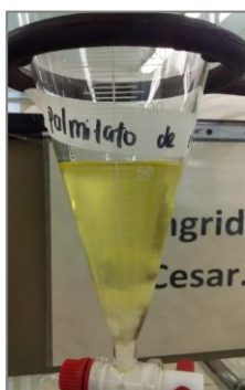
Figura 3. Reacción de esterificación del ácido palmítico
