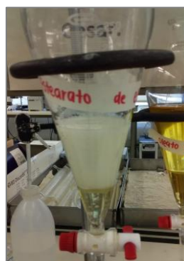
Figura 5. Reacción de esterificación del ácido esteárico
