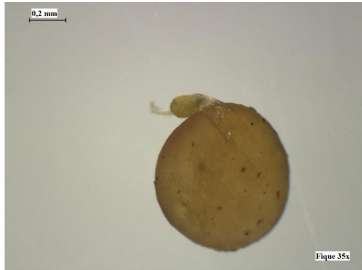
Figura 5. Morfología típica de las microcápsulas de fique
