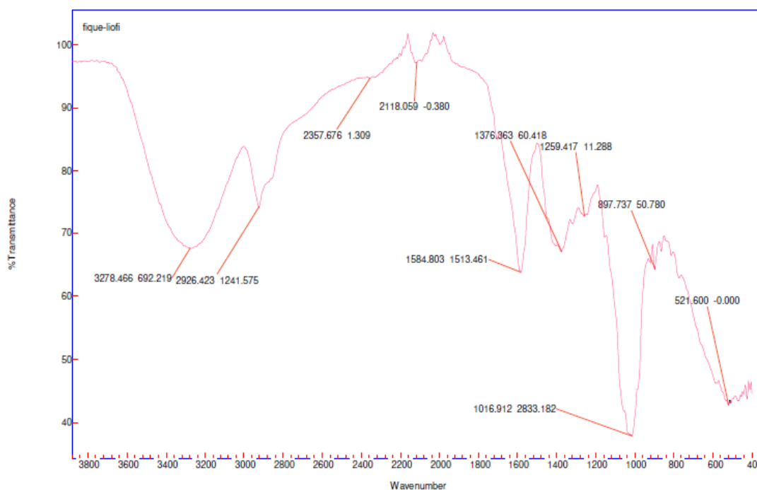
Figura A3-1. Espectrograma FTIR del Liofilizado de fique
