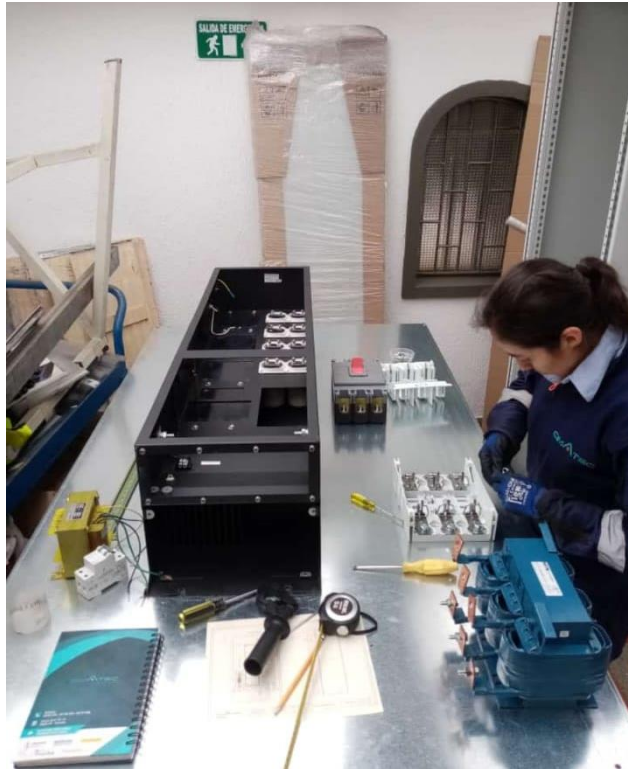
Fig. 9 Montaje de los elementos en la bandeja (doble fondo).
