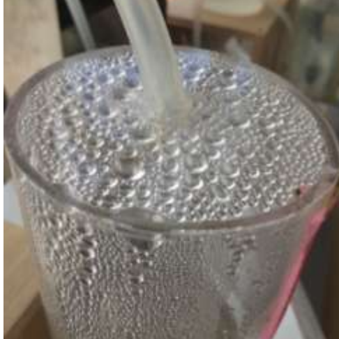
Figura 6: Formación de burbujas en cada probeta
