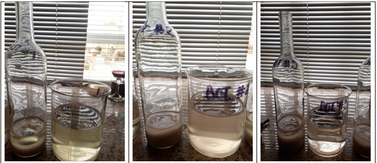
Ilustración 7. Resultados después de 24 horas de aplicar el test de bentonita.
