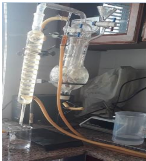
Ilustración 2. Equipo de arrastre de vapor para determinación de acidez volátil.
