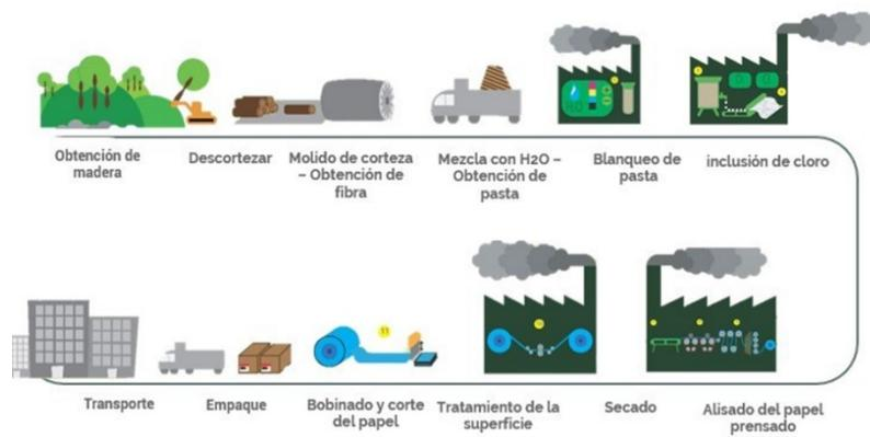
*Figura 11. Proceso de fabricación de papel*
