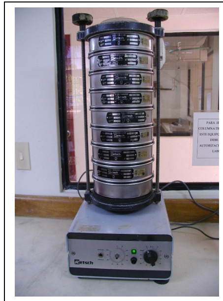
Figura 7. Columna de tamiz, Rota-Tap utilizada para el procedimiento granulométrico de las muestras recolectadas en la playa Arrecifes PNNT, 2005. Tomado: González, 2006
