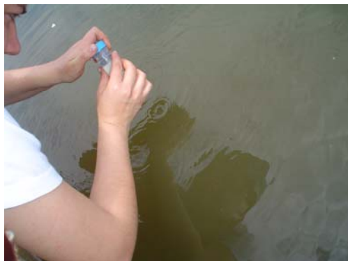
Figura 2. Imagen que describe la toma superficial de muestras de agua en el embalse de Betania
