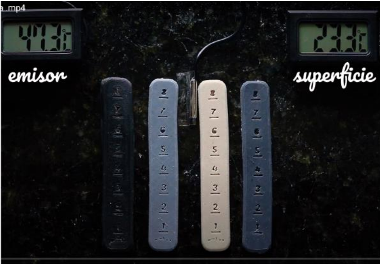
Fig. 11. Captura video, prueba de cambio de color por temperatura.
