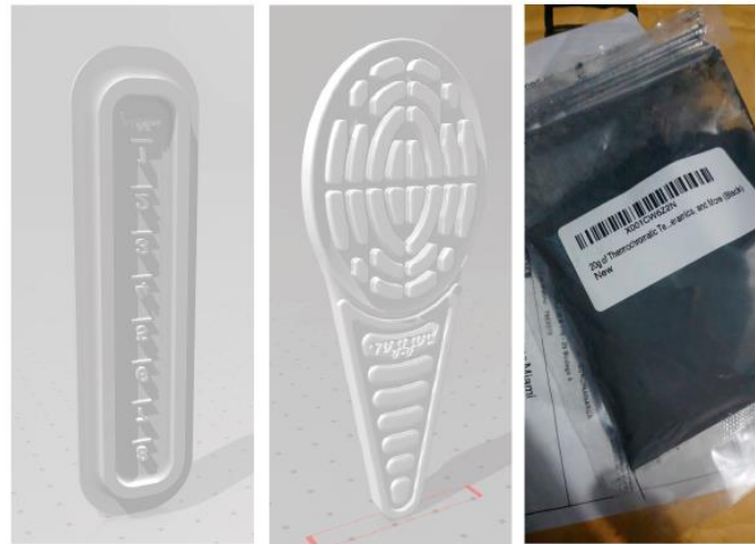
Fig. 9. primeras probetas en modelado 3D y pigmento termocrómico negro en polvo
