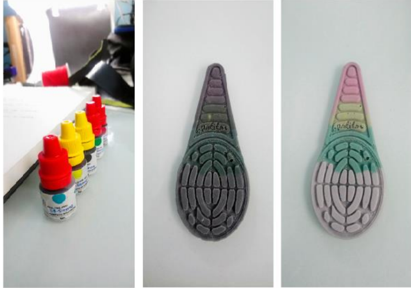
Fig. 20. Pigmentos incorporados al proceso, suela antes y después de ser sometida a temperatura.
