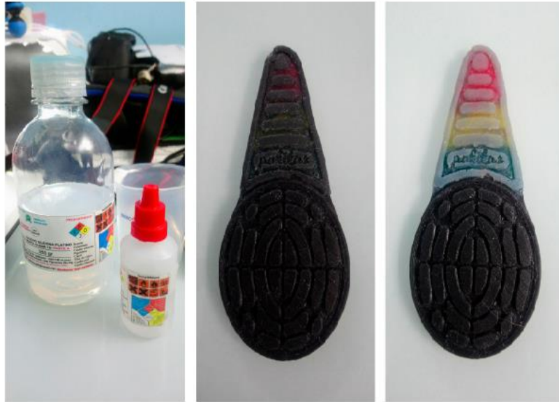
Fig. 21. Caucho silicona usado en la prueba 9, resultados antes y después de someter a temperatura con el nuevo material y sistema de aplicación por capas.
