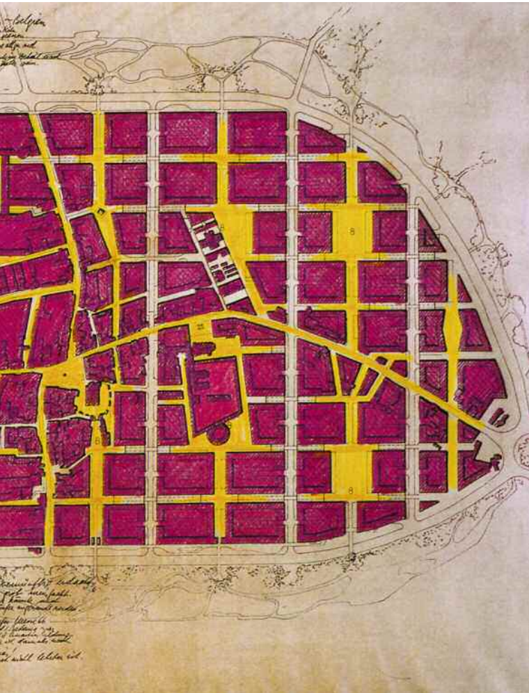
Lageplan der Stadterweiterung von Aalter; gelb die Fußgängerbereiche, die senkrecht an das historische Straßendorf andocken. Sie sind jeweils das Herz der neuen Quartiere. Erstmals kommt hier eine stadträumliche Komponente zum Ausdruck.
