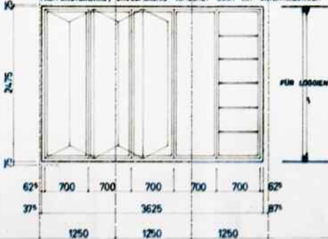
FALTFENSTERWAND, GROSSFLÄCHIG VERGLAST ODER MIT UNTERTEILUNGEN
