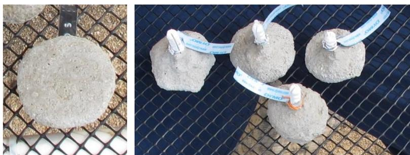
**Figura 4.** Pin de cemento elaborado para la alimentación de la guardería de coral. A la derecha está el lado liso del pin y a la izquierda el lado donde se ha colocado el chazo plástico estriado (Foto VCarrillo).
